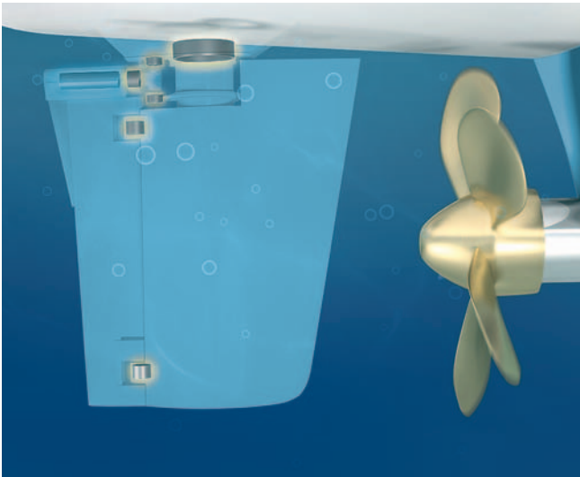
性能得到证明：舵轴承结构使用ELGOTEX® WA滑动轴承
