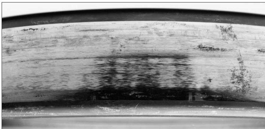
17：在内圈端面的周向划痕和冷焊是内圈在轴上蠕动的结果
