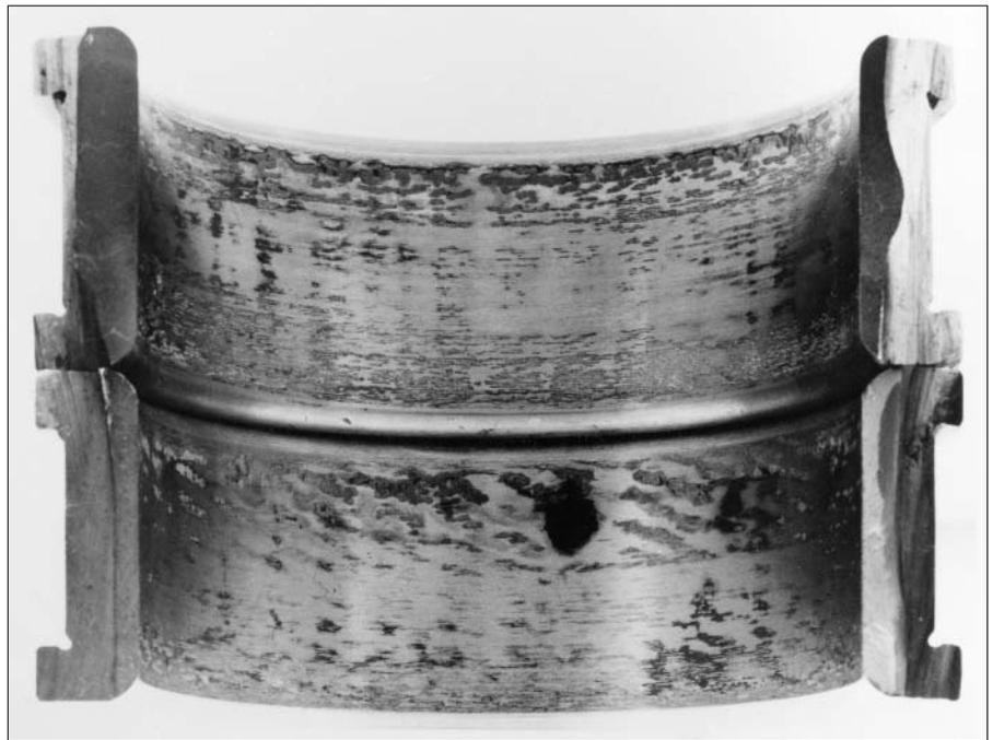
14：静止外圈上的微动腐蚀表明了承载区的范围
