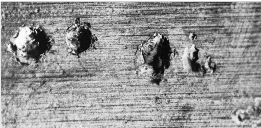
60：深沟球轴承外圈滚道上的凹槽由持续通过的电流造成。
