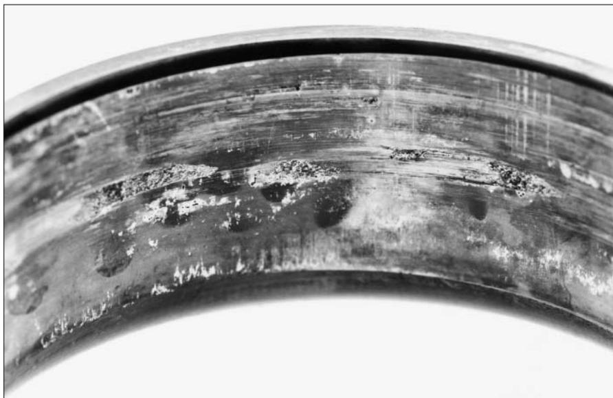
15：外圈外表面上的擦痕是外圈在轴承座里蠕动的结果
